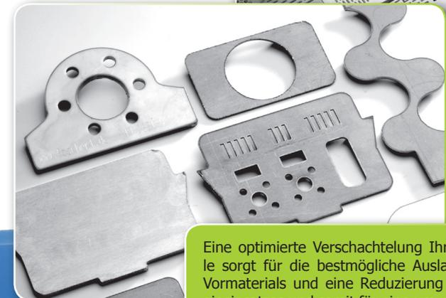
Eine optimierte Verschachtelung Ihrer Bauteile sorgt für die bestmögliche Auslastung des Vormaterials und eine Reduzierung des Energieeinsatzes und somit für eine umweltverträgliche Fertigung Ihrer Produkte.
